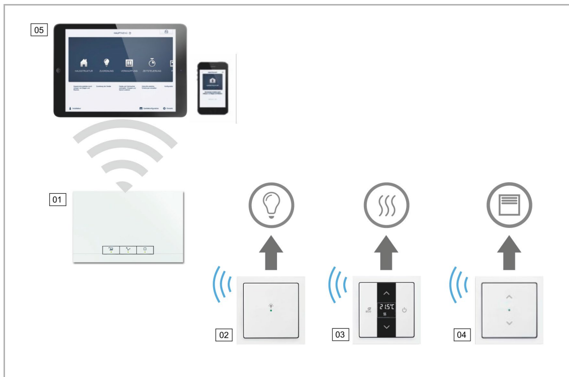
Obr. 5: Bezsběrníkové řešení systému
